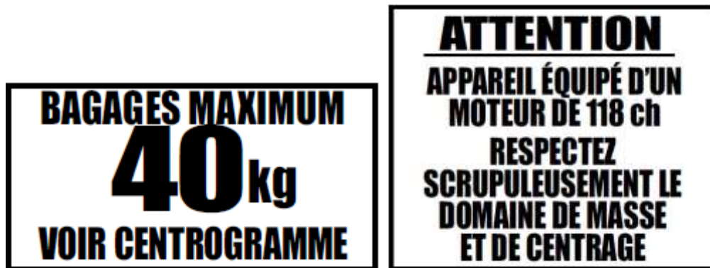
Figure 2-20 - Dans la soute à bagage ou sur la porte de coffre (côté intérieur)
